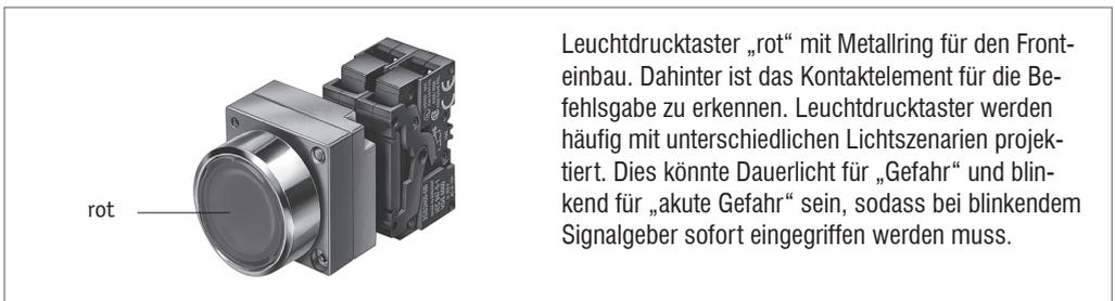
Leuchtdrucktaster „rot“ mit Metallring für den Fronteinbau. Dahinter ist das Kontaktelement für die Befehlsgebung zu erkennen. Leuchtdrucktaster werden häufig mit unterschiedlichen Lichtszenarien projektiert. Dies könnte Dauerlicht für „Gefahr“ und blinkend für „akute Gefahr“ sein, sodass bei blinkendem Signalgeber sofort eingegriffen werden muss.
