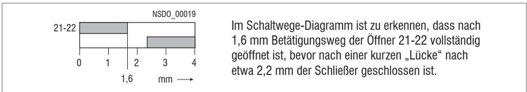
Im Schaltwege-Diagramm ist zu erkennen, dass nach 1,6 mm Betätigungsweg der Öffner 21-22 vollständig geöffnet ist, bevor nach einer kurzen „Lücke“ nach etwa 2,2 mm der Schließer geschlossen ist.
